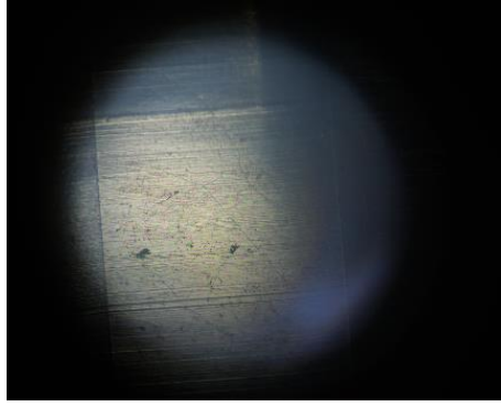
Şekil B.19. Deniz Ortamındaki PP Bardak Numunesinin Mikroskop Görüntüleri (Yukarıdan aşağıya sırasıyla 6.. ve 12. aylar verilmiştir).
