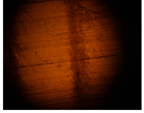
Şekil B.19. Deniz Ortamındaki PP Bardak Numunesinin Mikroskop Görüntüleri (Yukarıdan aşağıya sırasıyla 6.. ve 12. aylar verilmiştir).
