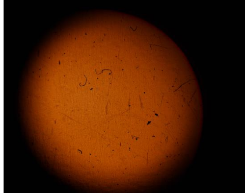
Şekil B.21. Göl Ortamındaki PP Bardak Numunesinin Mikroskop Görüntüleri (4. ay verilmiştir).
