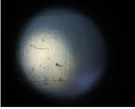
Şekil B.21. Göl Ortamındaki PP Bardak Numunesinin Mikroskop Görüntüleri (4. ay verilmiştir).
