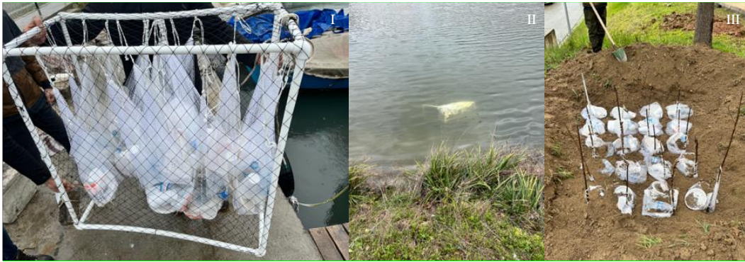
Şekil 3.2. Numune yerleştirme noktaları (I: tuzlu su, II: tatlı su ve III: toprak).
