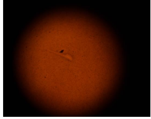
Şekil B.27. Göl Ortamındaki PLA Tabak Numunesinin Mikroskop Görüntüleri (4. ay verilmiştir).
