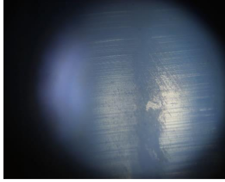
Şekil B.19. Deniz Ortamındaki PP Bardak Numunesinin Mikroskop Görüntüleri (Yukarıdan aşağıya sırasıyla 6.. ve 12. aylar verilmiştir).
