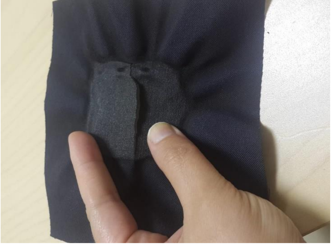
Şekil 5.1. Fire-resist isimli kumaş alev maruziyeti.
