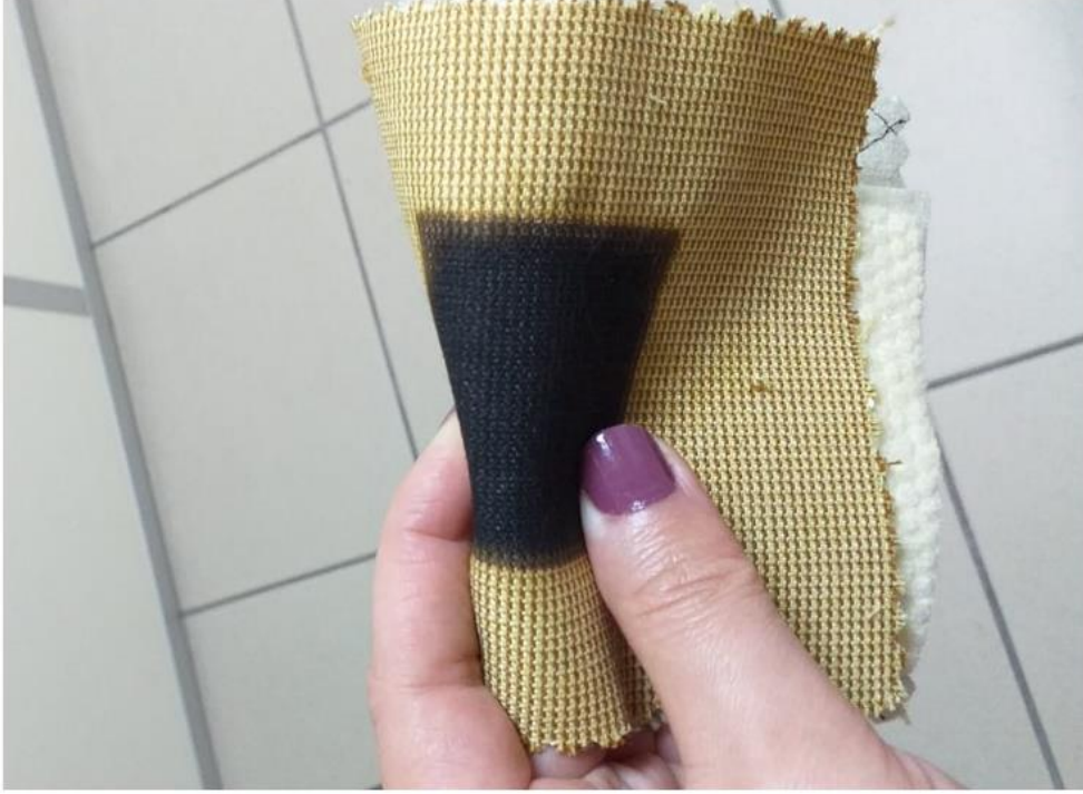
Şekil 5.2. PBI X55 isimli kumaş alev maruziyeti.
