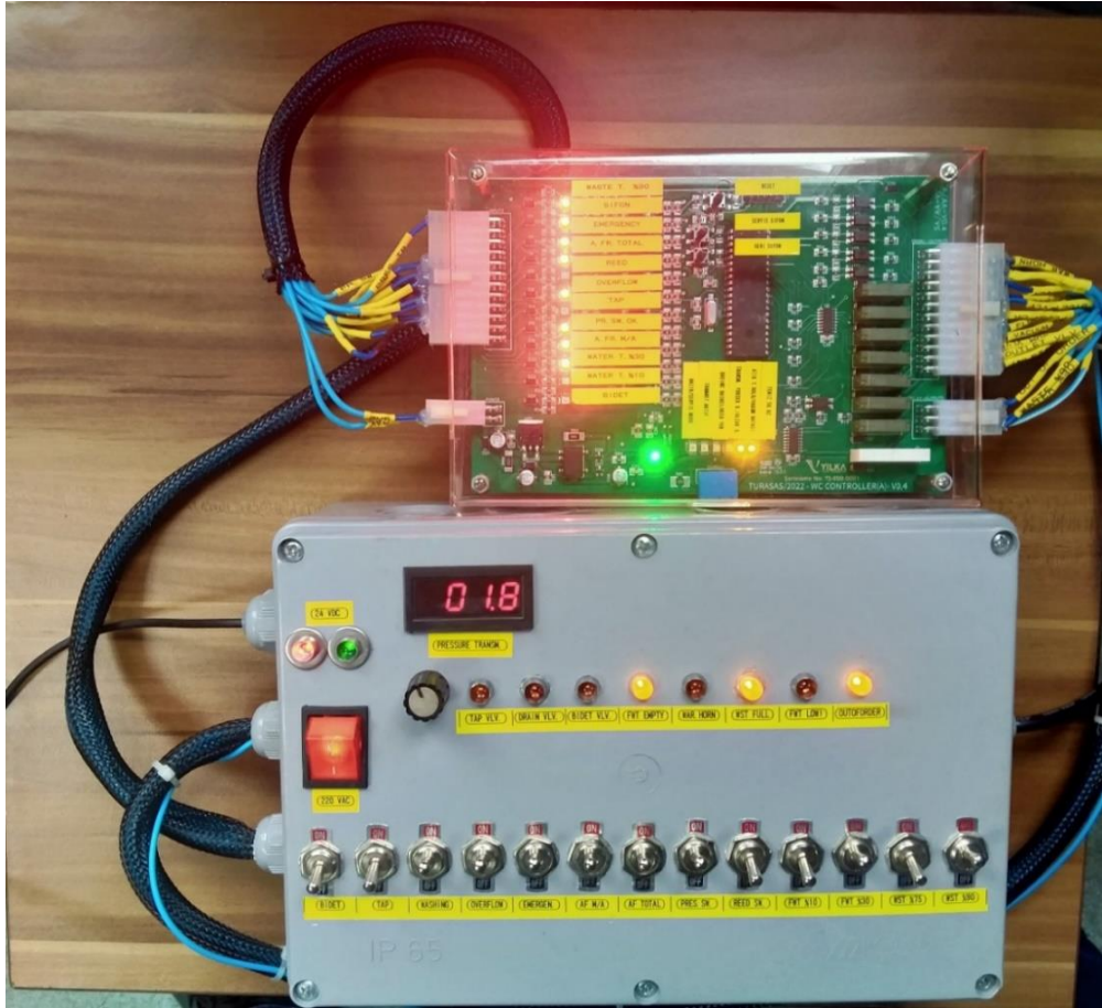
Şekil 4.3. VTS kontrolcüsünü test etmek için kullanılan test kutusu.
