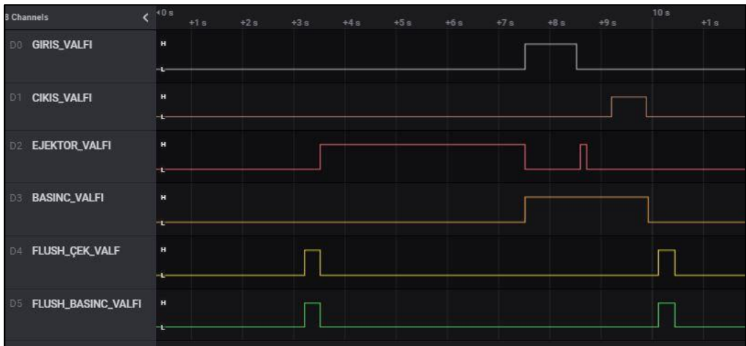
Şekil 3.9. Yıkama fonksiyonu valflerinin çalışma diyagramı.
