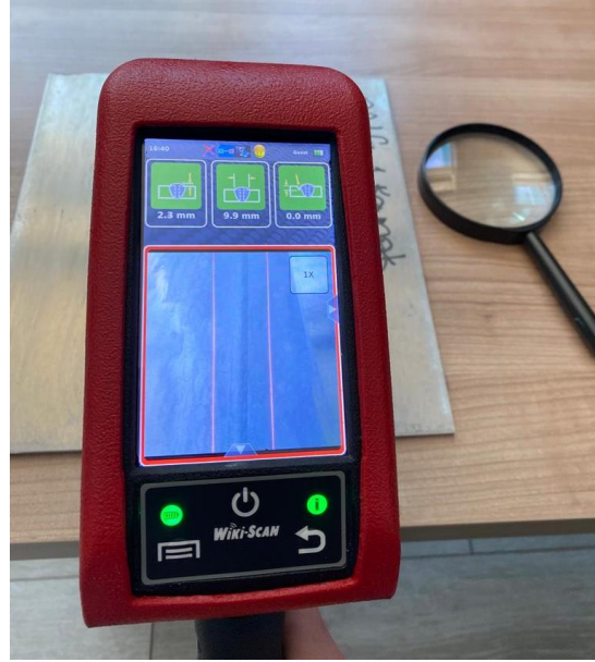
Şekil 6.1. Kaynak dikişi ölçüleri gösterimi.
