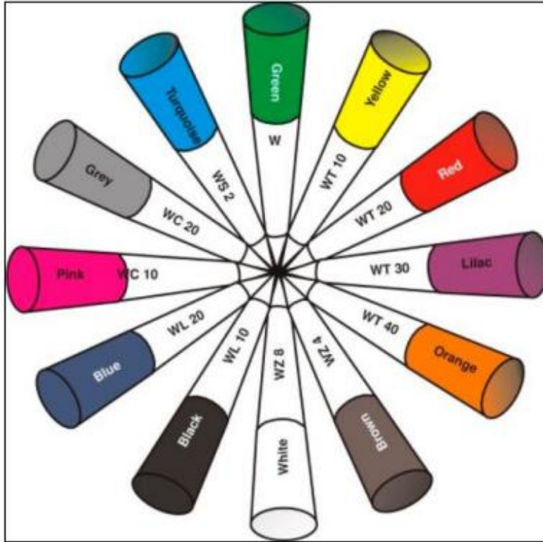
Şekil 3.16. Renklerine göre DIN standardı ile tanımlanan elektrotlar [28].
