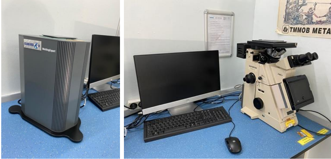
Şekil 5.8. a) Struers marka welding expert 5 makroyapı inceleme cihazı, b) Olympus marka optik mikroskop.
