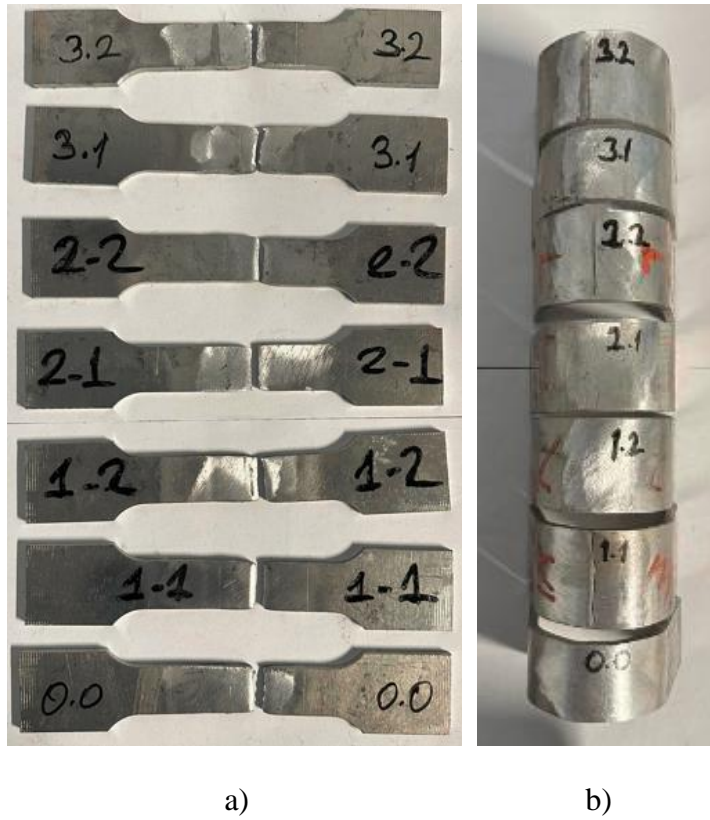
Şekil 6.8. a) Çekme ve b) eğme testi sonrası numunelere ait makro görüntüler.
