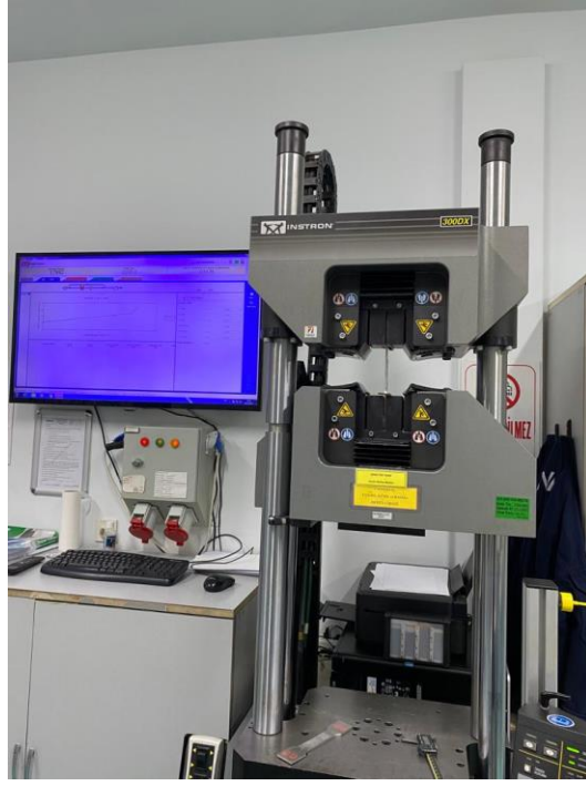
Şekil 5.13. Instron marka çekme test cihazı.
