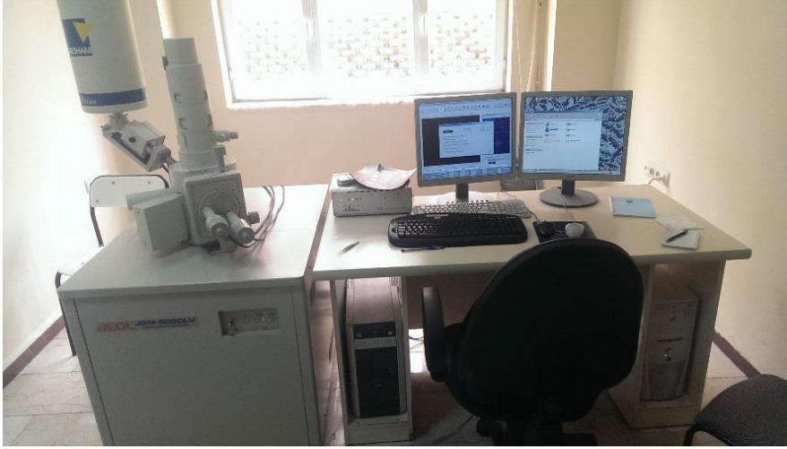
Şekil 5.9. Joel marka JSM-6060LV model SEM cihazı.
