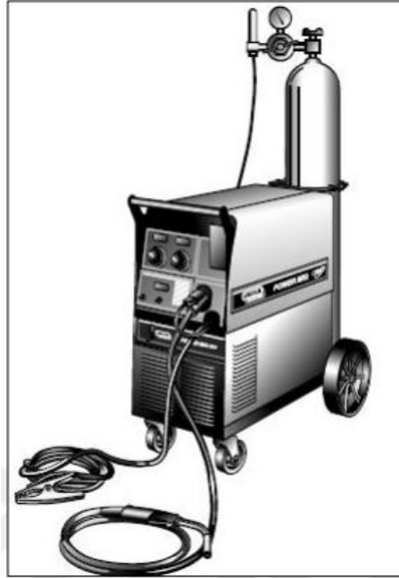
Şekil 3.3. MIG 350MP ünitesinin güç kaynağı [27].
