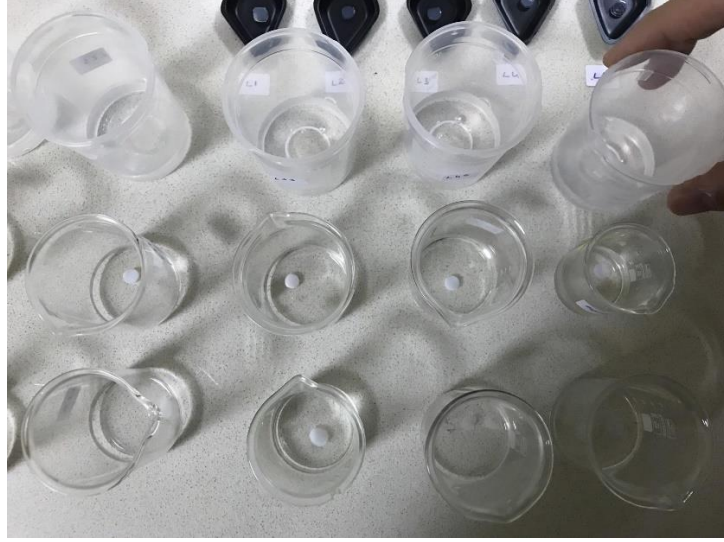
Şekil 3.3. Hidrojel örneklerine şişme testi yapılması.
