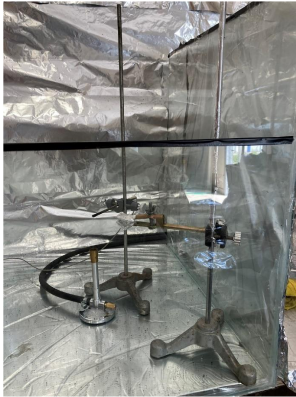
Şekil 3.19. Propan beki, standart hortumlar ve baėlayıcı kelepeler, thermocouple, ortamdaki akışı indirgemek iin cam kapamalar.
