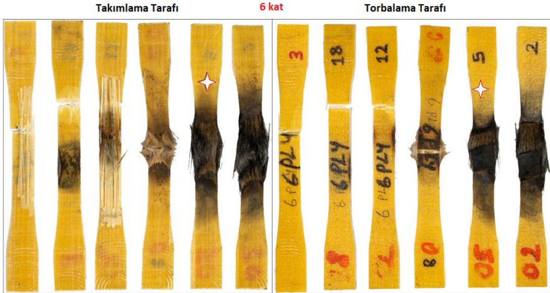
Şekil 3.46. Çekme deneyi sonrası, 6 kat numunelerin genel görünüşü.
