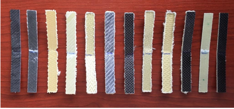
Şekil 4.22. Numunelerin eğme testi sonucu hali.
