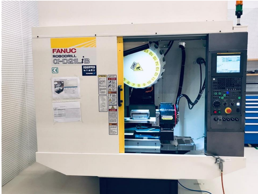
Şekil 2.3. Fanuc ROBODRILL alpha-21DLiB CNC dikey işleme merkezi
