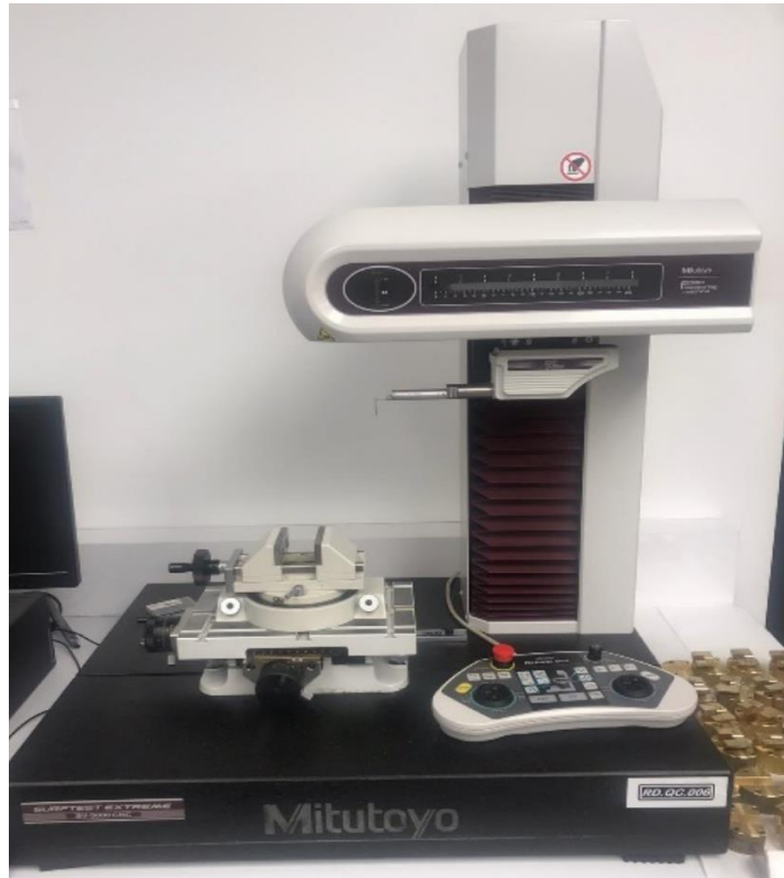
Şekil 2.6. Yüzey pürüzlülük ve form ölçüm cihazı
