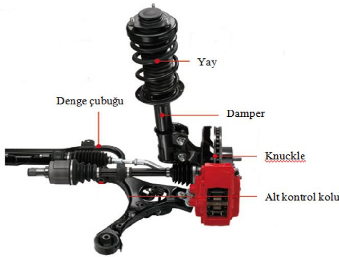
Şekil 5.5. MacPherson Süspansiyon Sistemi Ön Aks Elemanları [39]
