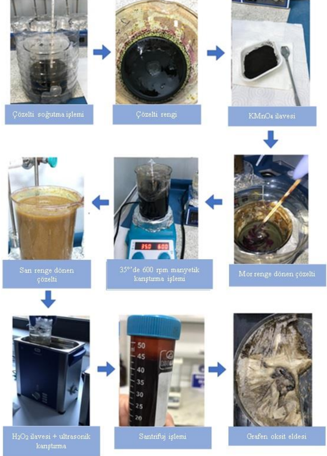
Şekil 4.1. Pulcuklu grafitten grafen oksit üretim aşamaları.
