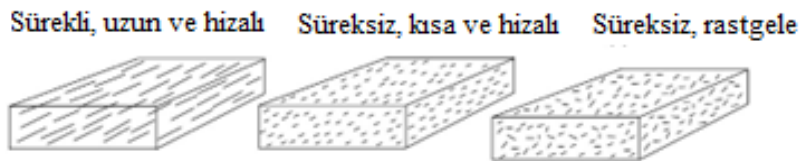
Şekil 2.8. Fiber partikül takviyeli kompozit şeması [23].
