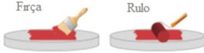
Şekil 3.1. Rulo ve fırça ile sol-jel kaplama yöntemi [10].
