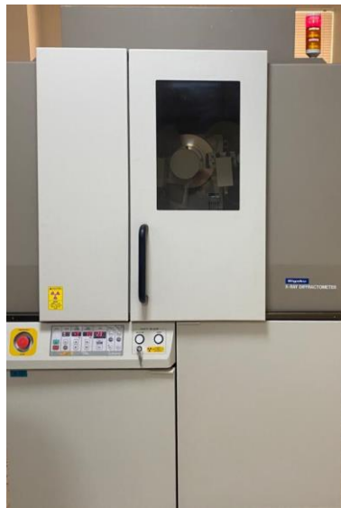
Şekil 4.6. Analiz yönteminde kullanılan X-ışınları difraktometresi.
