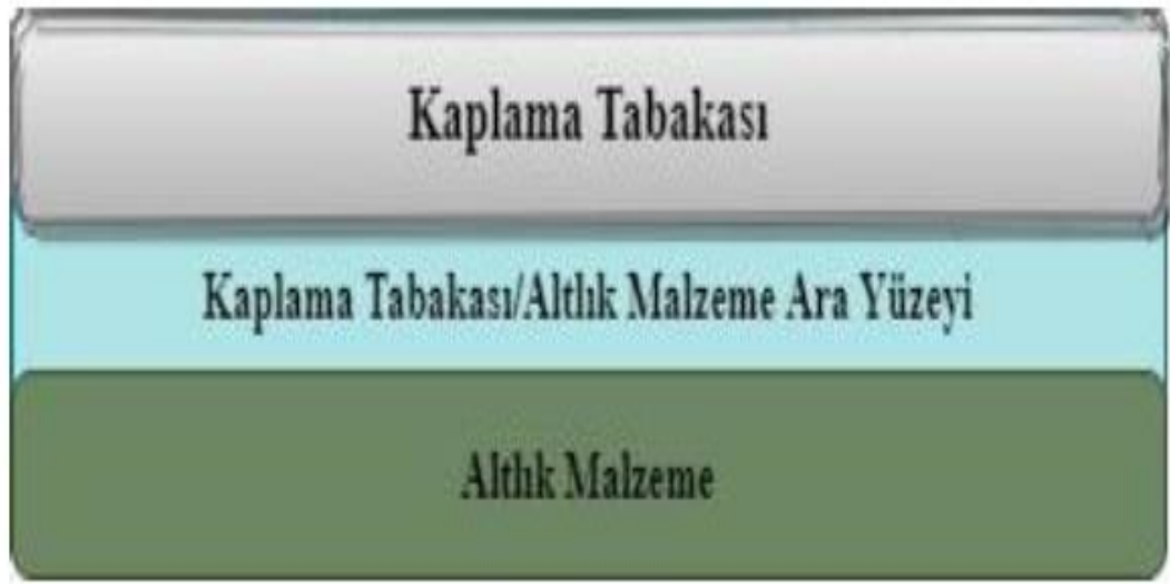
Şekil 3.2. Kaplama işlemi neticesinde oluşan bölgeler [42].
