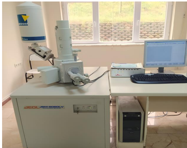
Şekil 4.8. JEOL JSM – 6060 marka taramalı elektron mikroskop görüntüsü.
