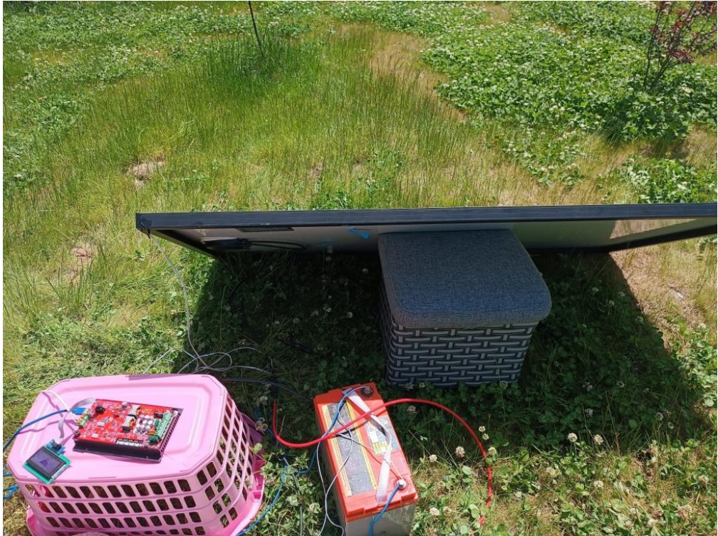
Şekil 6.1. Gerçek zamanlı uygulama testi için kurulan off-grid GES düzeneği-1
