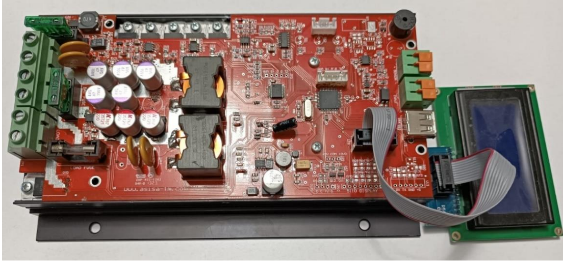
Şekil 6.3. Geliştirilen 30 amper 12/24 volt çift katmanlı interleaved buck çevirici tabanlı solar MPPT şarj düzenleyici (regülâtör)
