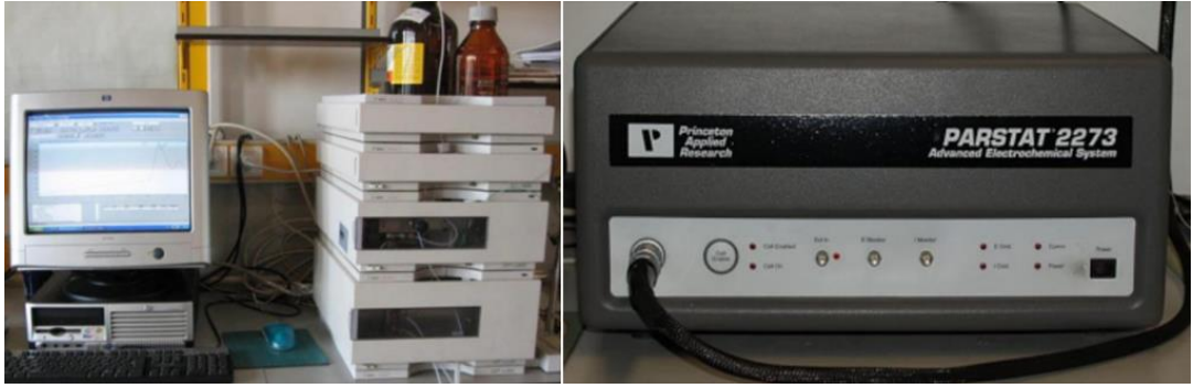
Şekil 4.3. a) PBZ polimerlerinin molekül ağırlığı ölçümlerinin yapıldığı GPC ölçüm cihazı, b) PBZ polimerlerinin güneş pili uygulamalarının yapıldığı potansiyostat cihazı.
