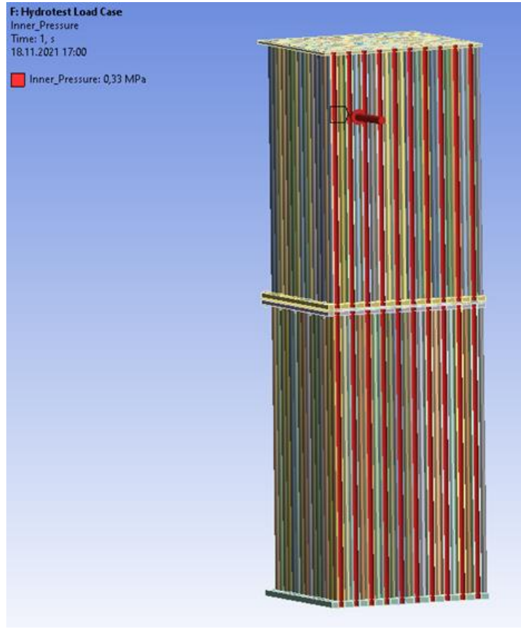
Őekil 4.33. Yk Durumu 03 Hidro-Test Basıncı
