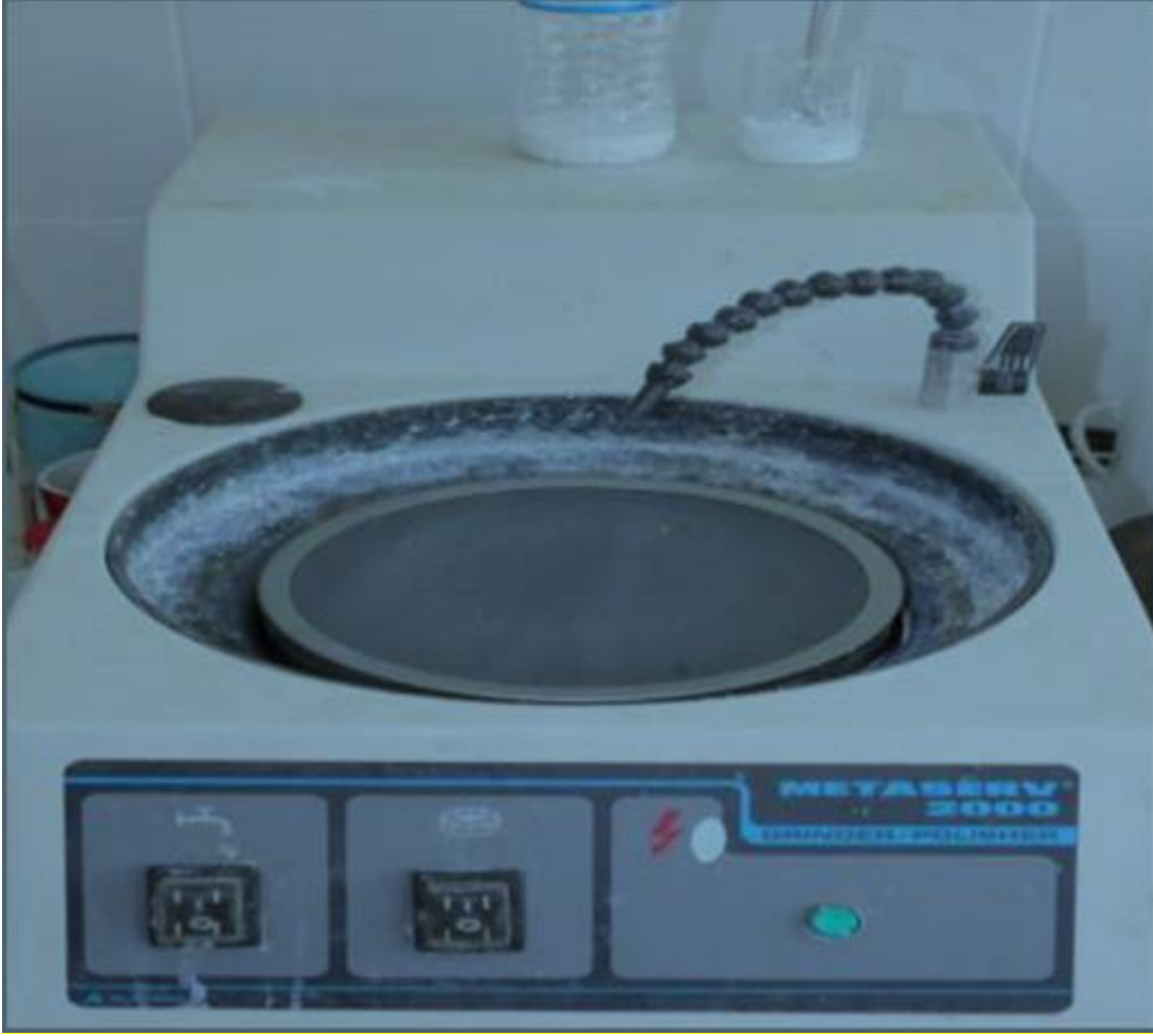
Şekil 3.3. Metalografik incelemede zımparalama işleminin gerçekleştirildiği cihaz.
