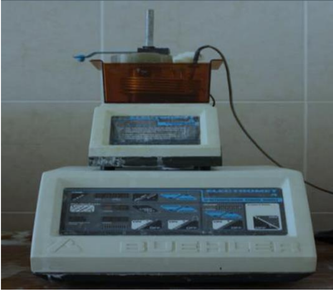
Şekil 3.6. Metalografik incelemede kullanılan elektrolitik parlatma cihazı.
