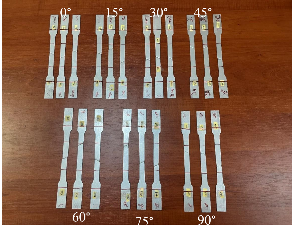
Şekil D.5. Farklı oryantasyonlarda kesilen DP800 test numunelerinin çekme testi sonrası kırılmış görüntüsü.
