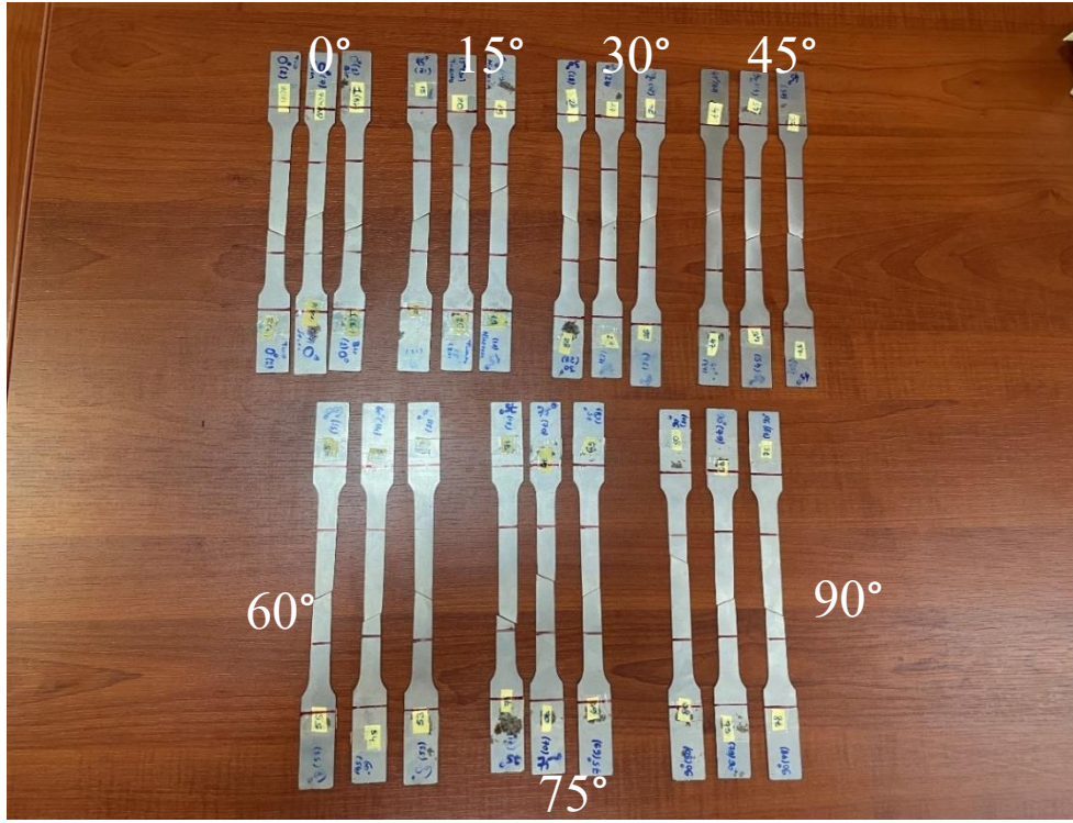
Şekil D.1. Farklı oryantasyonlarda kesilen DP600 test numunelerinin çekme testi sonrası kırılmış görüntüsü.
