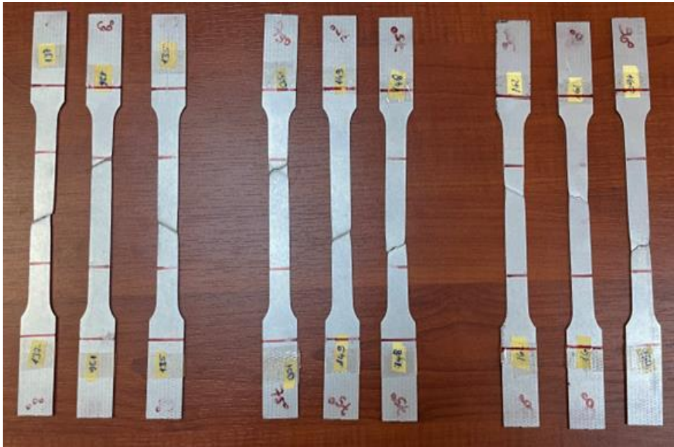
Şekil D.8. 60°, 75° ve 90° açılı doğrultularda kesilen DP800 test numunelerinin çekme testi sonrası kırılmış görüntüsü.
