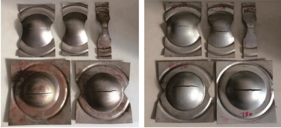
Şekil 3.5. Örnek çeliklere aittir yırtılmış Nakajima test numuneleri: (a) DP590, (b) DP780 [6].
