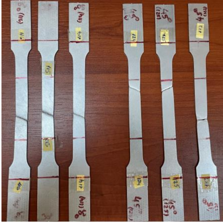
Şekil D.7. 30° ve 45° açılı doğrultularda kesilen DP800 test numunelerinin çekme testi sonrası kırılmış görüntüsü.
