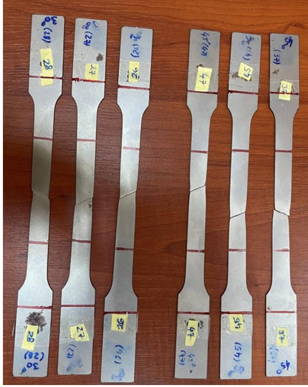
Şekil D.3. 30° ve 45° açılı doğrultularda kesilen DP600 test numunelerinin çekme testi sonrası kırılmış görüntüsü.
