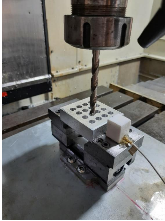
Şekil 4.4. HSS matkap ile delik delinen numune.
