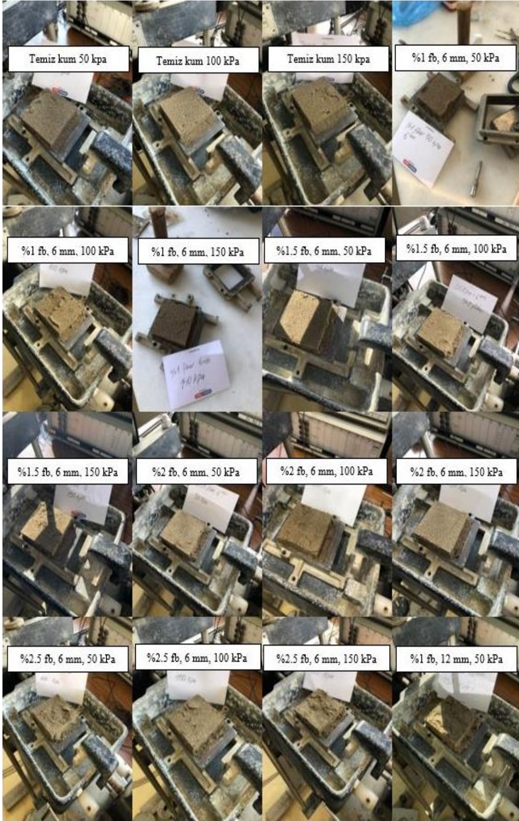
Şekil 4.9. Kesme kutusu deneyine tabi tutulmuş numunelerin tümü.
