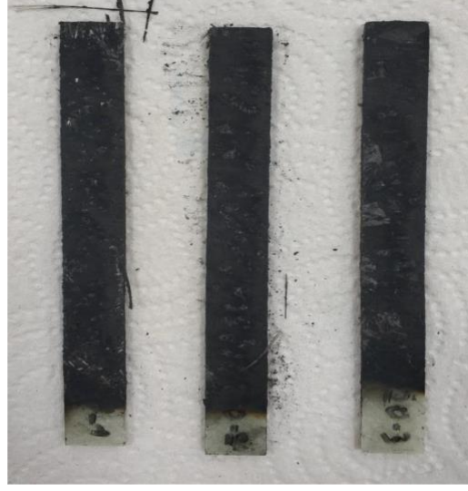
Şekil 5.14. %20 Çinko Borat katkısı eklenmiş numunelerin yanma sonrası görüntüsü
