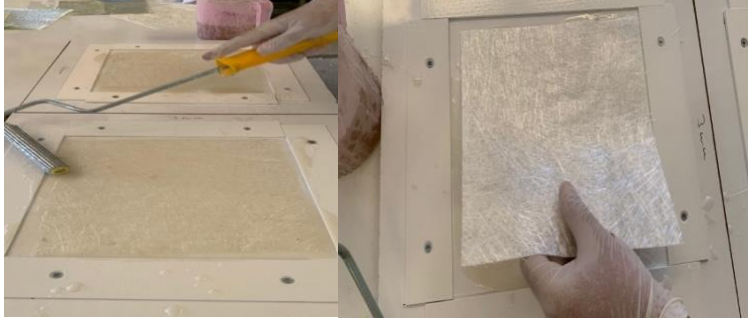
Şekil 4.6. Kalıplara takviye ve matrisin rulo fırça ile uygulanması
