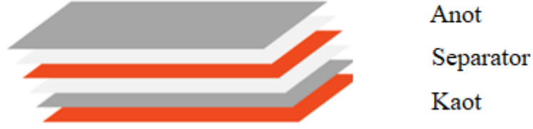
Şekil 2.1. Bir sodyum iyon pilde katman istifleme düzenlemesininin gösterimi [19].
