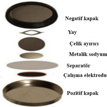
Şekil 4.5. Yarım hücre montajının şematik gösterimi [3].
