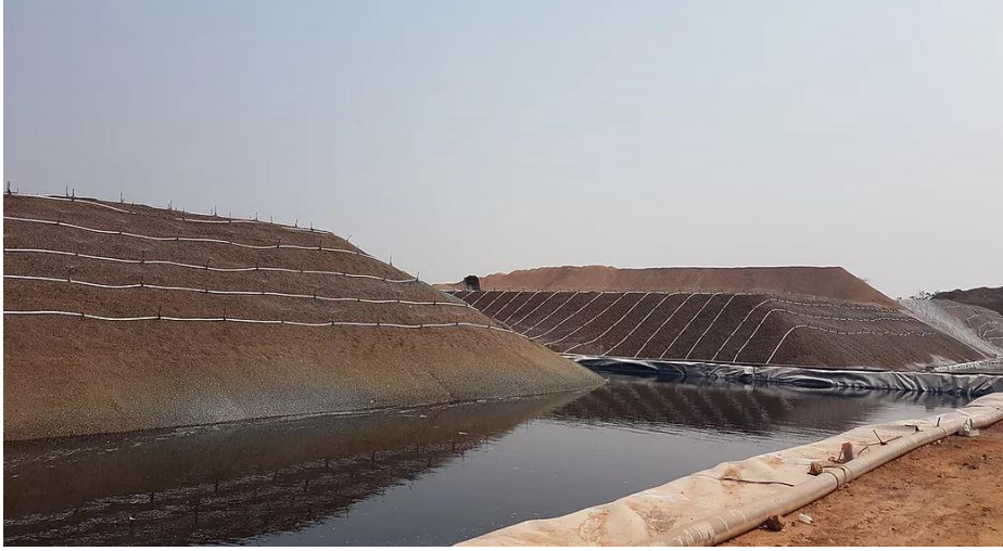
Şekil 2.19. Bakır cevherinin yığın liçi örneği (ARS, 2022.)
