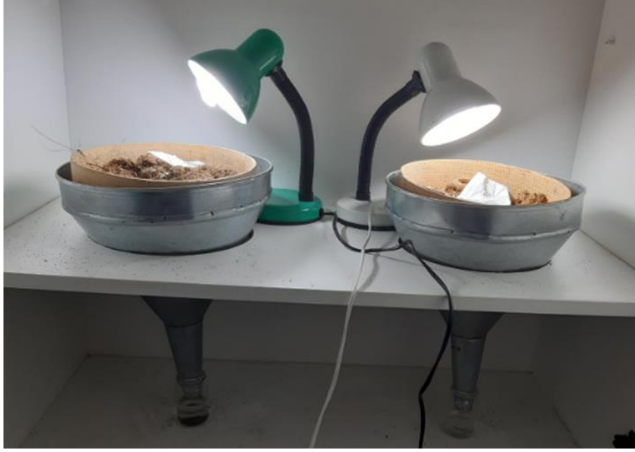
Şekil 2.2. Berlese hunilerinden oluşan ayıklama düzeneği
