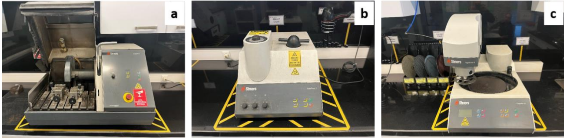
Şekil 3.7. Metalografi a) Kesme, b) Bakalitleme c) Yüzey hazırlama cihazları.
