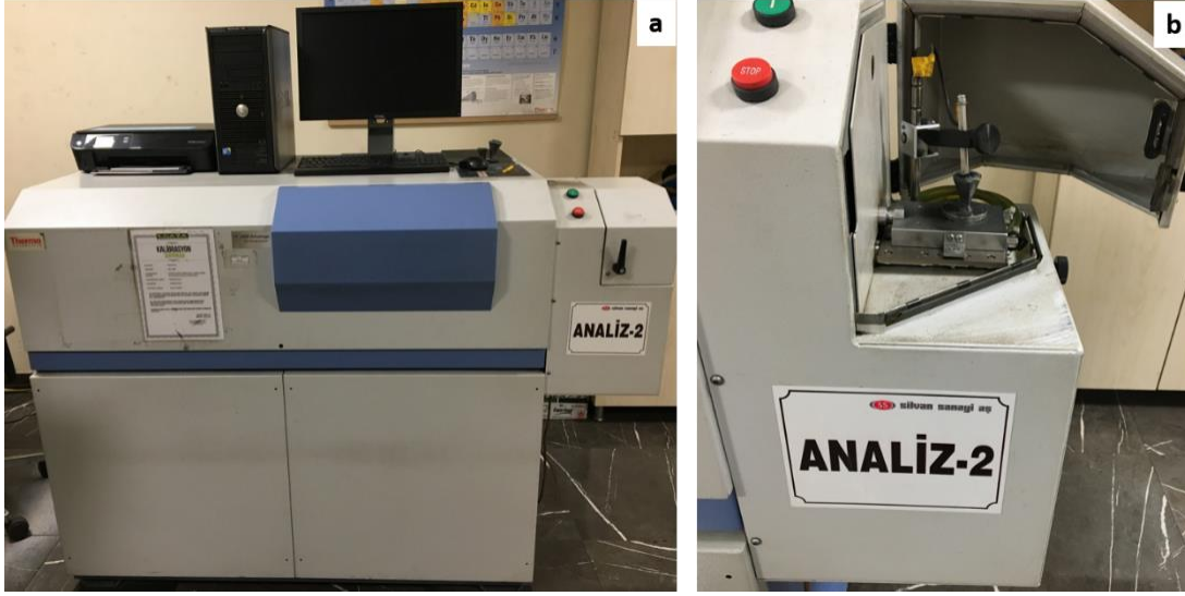
Şekil 3.4. Spektrometral ölçüm cihazı; a) Genel görünümü, b) Numune haznesinin detay görünümü.
