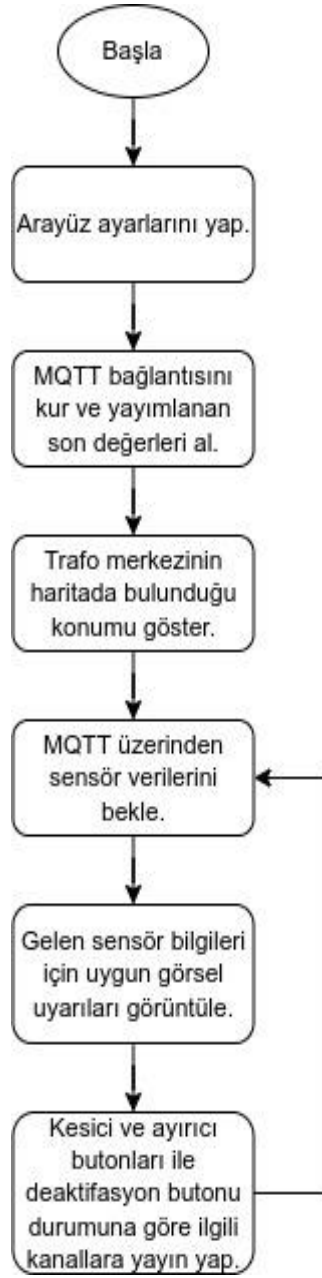
Şekil 3.15. Arayüz programının akış şeması.
