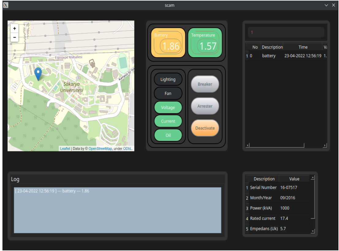
Şekil 4.5. Düşük batarya gerilimi uyarısına ait ekran görüntüsü.
