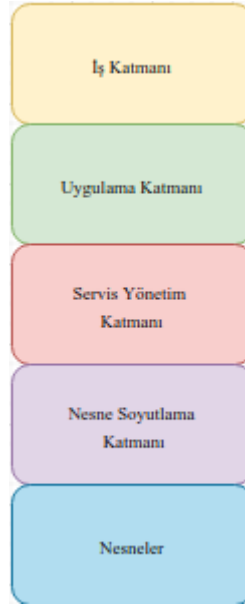
Şekil 2.1. Beş katmanlı Nİ mimarisi.
