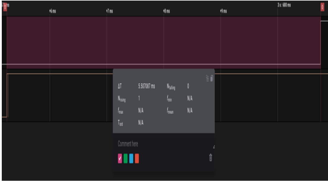
Şekil 4.13. Gerilim sensörüne ESP32 kitinin verdiği tepki süresine ait görüntü.
