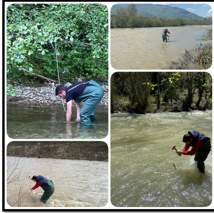
Şekil 4.5. Çözünmüş oksijen ( \text{ÇÖ} ) ve su sıcaklığı ( T_{\text{su}} ) ölçüm cihazlarının akarsu yatağına yerleştirilmesi.
