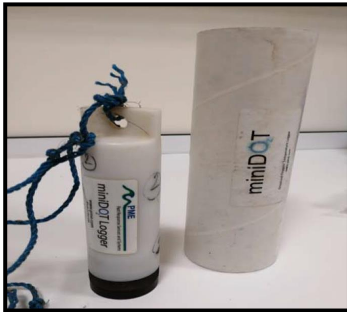
Şekil 4.2. Çalışmada çözülmüş oksijen (ÇO) ve su sıcaklığı ( T_{su} ) ölçümleri için kullanılan PME MiniDOT Data Logger cihazı.
