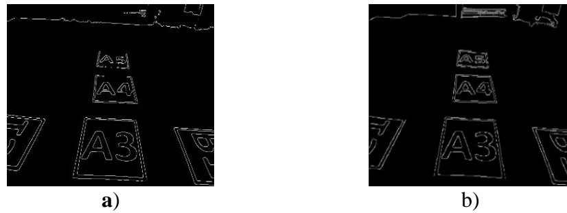
Şekil 4.2. Otsu ve Canny algoritmalarının uygulanması. a) Otsu ve Canny algoritmaları uygulanmış görüntü, b) Canny algoritması uygulanmış görüntü.
