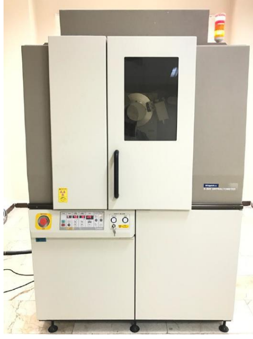
Şekil 3.2. Rigaku D/Max 2200 XRD cihazı.
