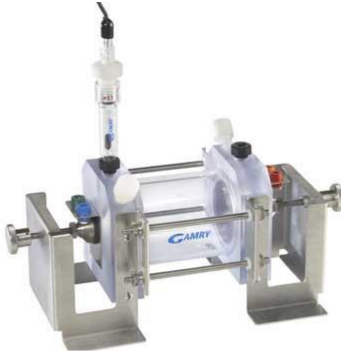
Şekil 3.5. Deneysel çalışmalarda kullanılan korozyon hücresi.
