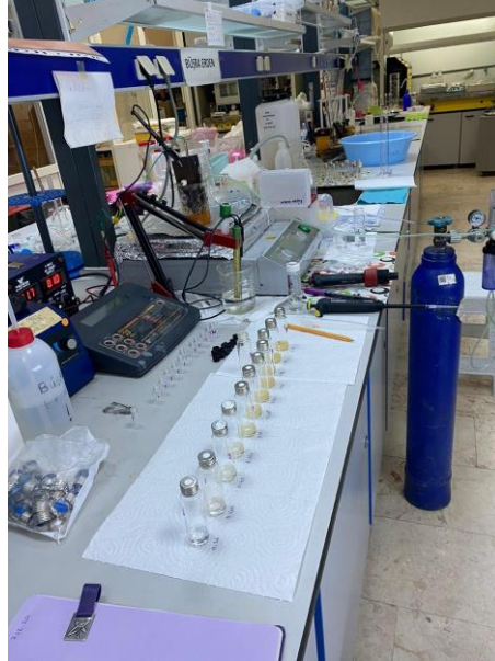
Şekil 3.12. Elektro-Fenton deneyinin laboratuvar ortamındaki düzeneği
