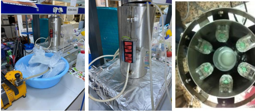
Şekil 3.14. Foto-Fenton deneyinin laboratuvar ortamındaki düzeneği
