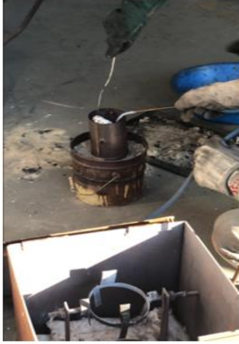
Şekil 4.4. Döküm işlemi öncesi sıvı metale alaşım elementlerinin ilavesi.
