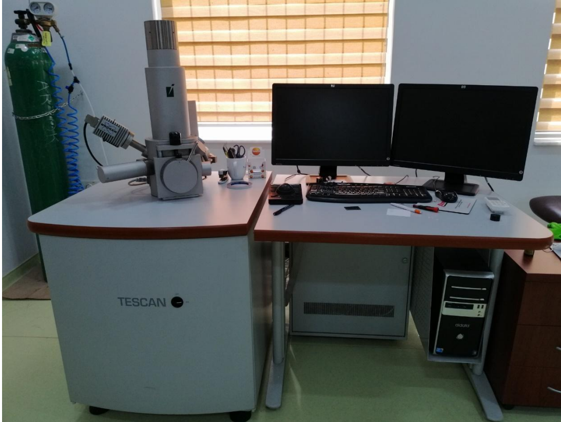
Şekil 4.13. Tescan VEGA-II Elektron Mikroskobu.
