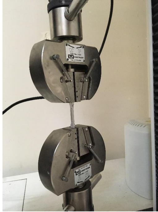
Şekil 4.20. Çekme deneylerinin yapıldığı Instron 3367 marka çekme cihazı.
