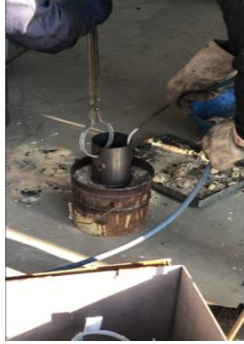
Şekil 4.4. Döküm işlemi öncesi sıvı metale alaşım elementlerinin ilavesi.
