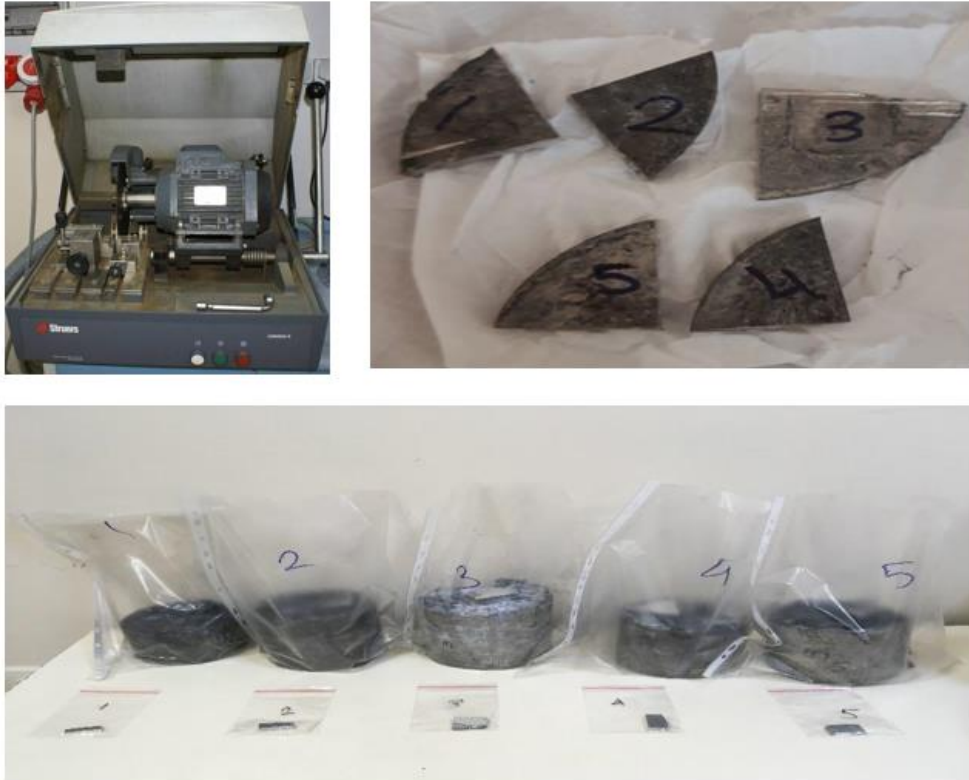
Şekil 4.8. Struers marka numune kesme cihazı ve kimyasal analiz için hazırlanan numuneler.
