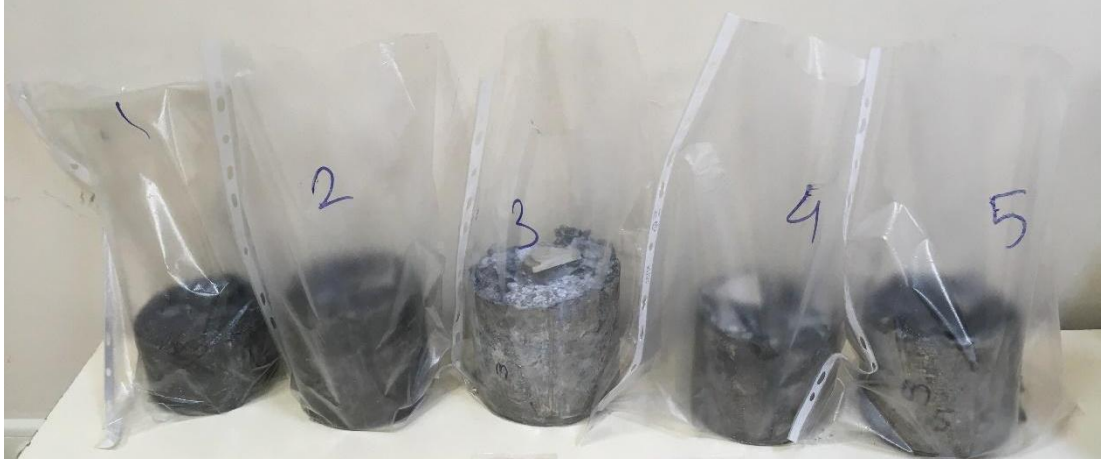
Şekil 4.7. Döküm işlemi sonrası kalıptan çıkarılan Mg-8Li-2Al, Mg-8Li-2Al-1,5Sn, Mg-8Li-2Al-1,5La, Mg-8Li-2Al-1,5Nd ve Mg-8Li-2Al-1,5Ca alaşımları.
