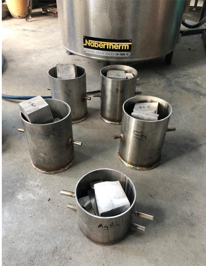
Şekil 4.2. Ergitme işlemi öncesi paslanmaz potalara yerleştirilmiş malzemeler.
