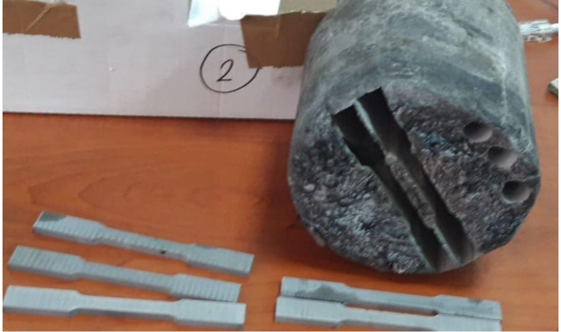
Şekil 4.18. Tel erozyon cihazında işlenmiş, zımparalama işlemi öncesi çekme deneyi numunelerinin görüntüsü.
