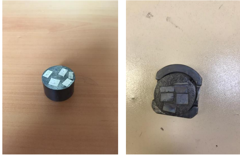
Şekil 4.11. Metalografik inceleme için hazırlanmış numune örnekleri.
