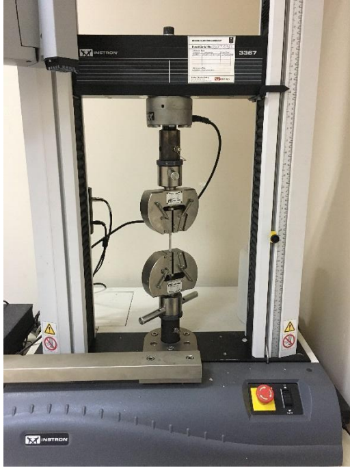
Şekil 4.20. Çekme deneylerinin yapıldığı Instron 3367 marka çekme cihazı.
