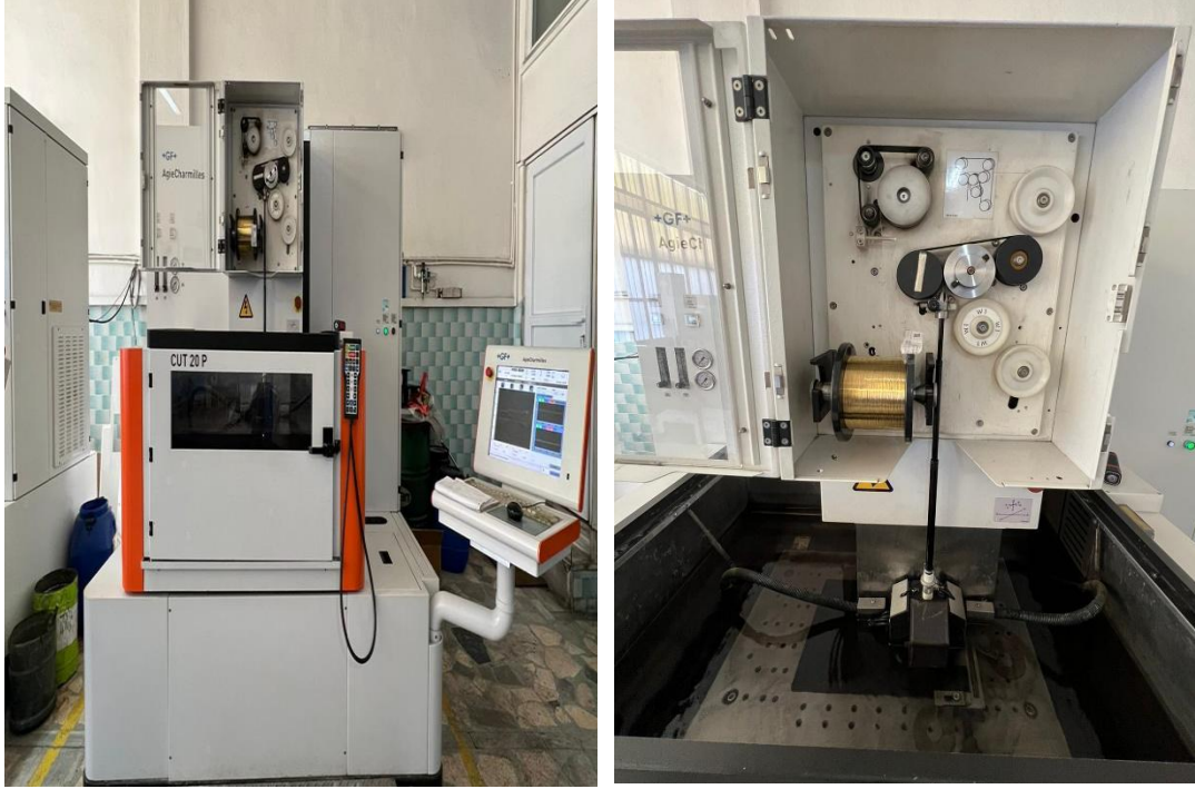
Şekil 4.15. GF marka tel erozyon işleme cihazı
