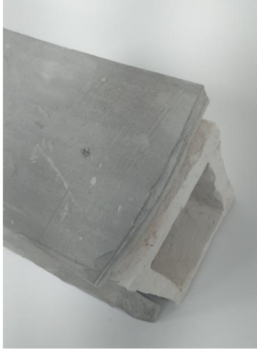
Görsel 60: İç Kalıp, İç Çekirdek İle Ara Katman Plakadan Hazırlanan İç Kalıp Duvarların Detayları
