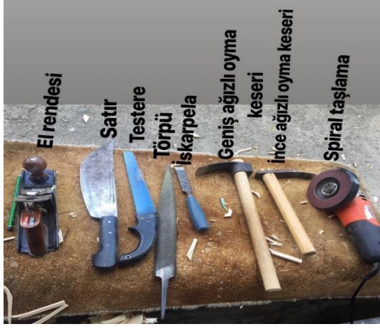
Kemane Yapımı Aşamasında Kullanılan Tüm Aletler
