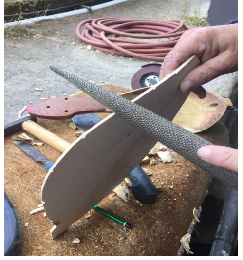
Ses tahtasının hazırlanma ve formunun verililiş aşaması
