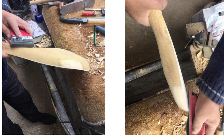
Resim 23: Takoz zımpara yardımıyla teknenin ve ses tahtasının cilalanmasından önceki son tesviye işlemi
