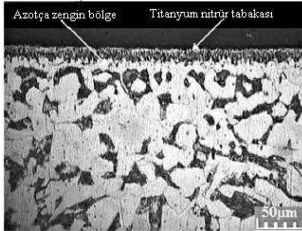
Şekil 5.3. AISI 1020 çeliği üzerine uygulanmış Ti-N kaplama tabakası [64]
