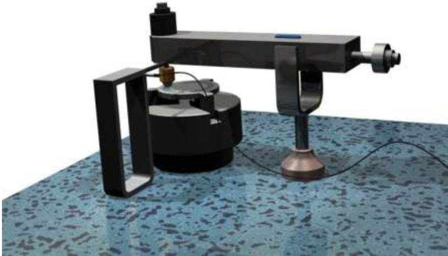
Şekil 6.4. Aşınma cihazının şematik gösterimi [6]
