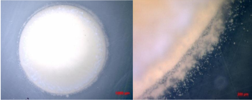
Şekil 6.23. 48 saatlik inkübasyon ardından ticari hidroksiapatit disk yüzeyinde ve etrafında meydana gelen E. coli bakteri üremesi.
