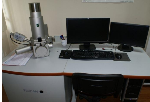
Şekil 5.17. Vega Tescan II marka SEM cihazı.
