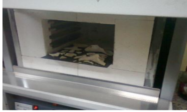
Şekil 5.6. Organiklerin uzaklaştırılmasında kullanılan kül fırını.
