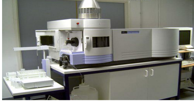
Şekil 5.20. Perkin Elmer Optima 2100 marka ICP cihazı.
