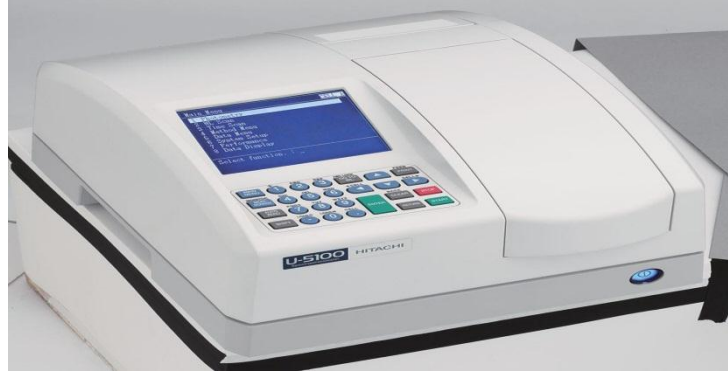
Şekil 5.27. koloni sayma metodunda kullanılan spektrometre cihazı.
