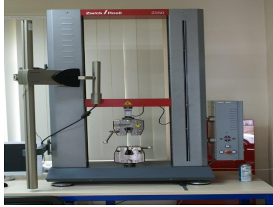
Şekil 5.23. Zwick marka çekme/basma test cihazı.
