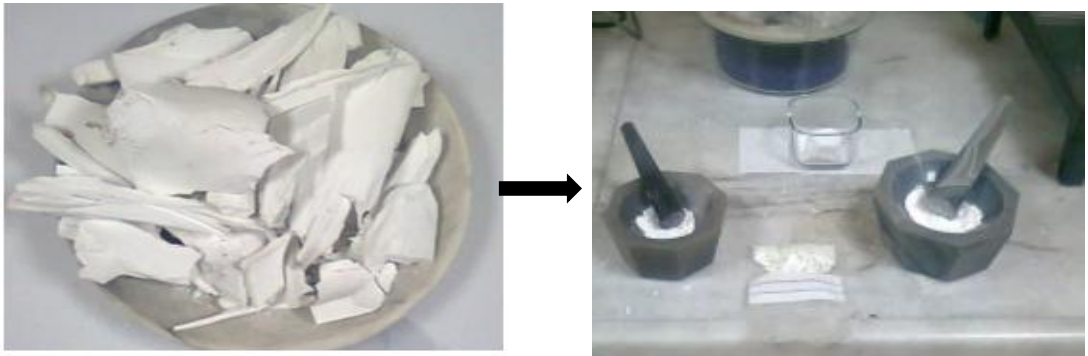
Şekil 5.7. HA kütlelerinin kaba öğütülmesi.
