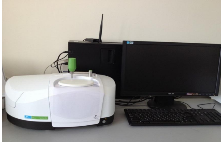
Şekil 5.21. Perkin Elmer Spectrum 100 marka FTIR cihazı.
