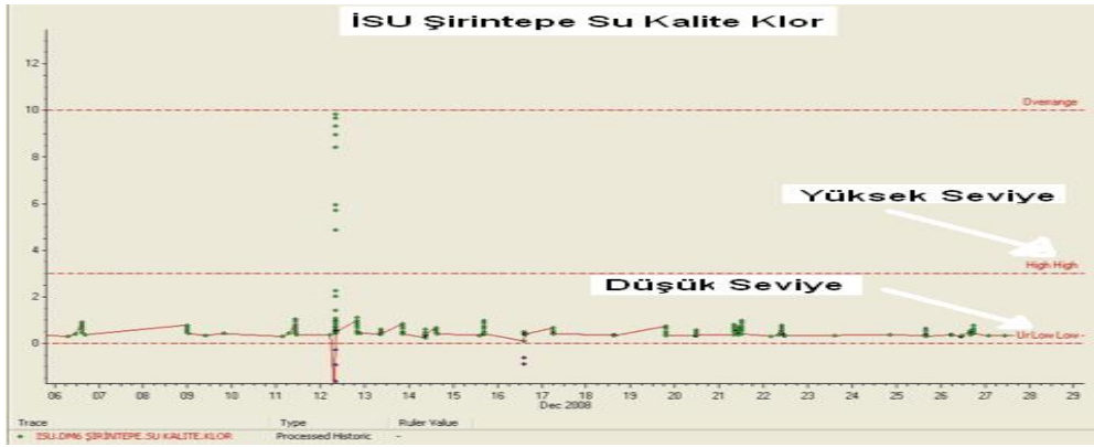
Şekil 3.4. İSU Genel Müdürlüğü Scada sistemi kontrol merkezinden takip edilen parametrelerden biri olan su kalite (klor) parametresi online ölçümünün zamana bağlı değişimi grafiği
