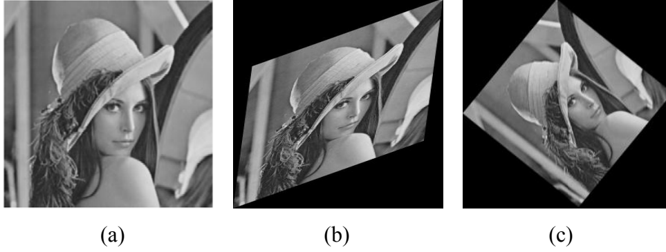
Şekil 3.1. Moment tabanlı görüntü normalleştirilmesinin etkisi. (a) Orijinal Lena görüntüsü, (b) bozulmuş Lena görüntüsü, (c) (a) ve (b)'deki görüntülerin normalleştirilmesinden elde edilen görüntü
