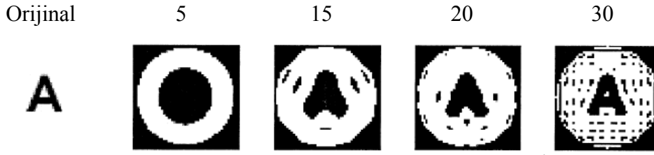
Şekil 2.13. A harfinin Zernike momentlerinden geri çatılması. Soldan sağa: orijinal görüntü, n_{max} = 5, 15, 20, 30 için geri elde edilmiş görüntüler (IEEE'nin izni ile [51]'den uyarlanmıştır)
