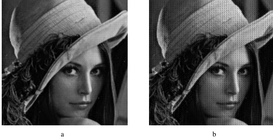
Şekil 3.6. Düşük çözünürlüklü görüntü sayısının etkisi. a. K = 10 için sonuç (MSE = 9.89). b. K = 9 için sonuç (MSE = 155.98).
