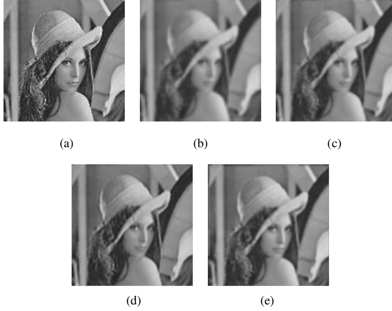
Şekil 5.11. Gauss bulanıklığı durumunda süper-çözünürlük sonuçları. a. Orjinal görüntü. b. Düşük çözünürlüklü görüntülerden biri (aradeğerlenmiş). c. Bölüm 4'deki yöntemin sonucu. d. Yeni yöntemin sonucu. e. Çift taraflı kaydır-ve-ekle yönteminin sonucu.
