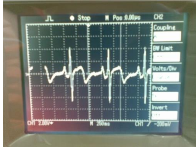
Şekil 3.30. CCII yapısı içermeyen devre osiloskop çıkışı (Canal ve ark., 2011).
