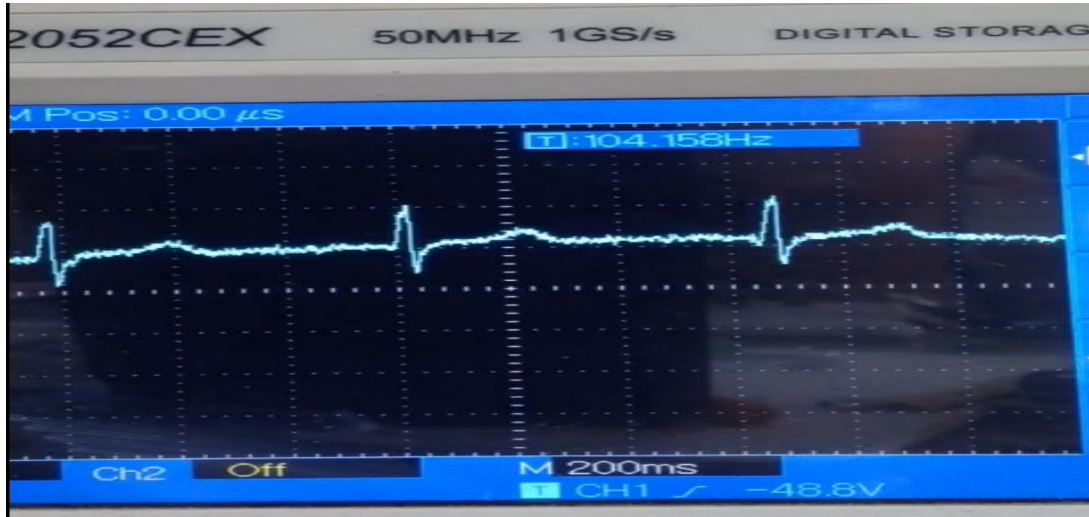
Şekil 3.40. EKG devresi ölçüm sonucu.
