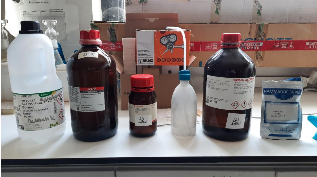
Şekil 4.1. Bu deneyde kullanılan malzemeler. Soldan sağa doğru; Etanol, Titanyum izopropoksit, TiO 2 nanotoz, damıtılmış su, hidroklorik asit ve stearik asit.
