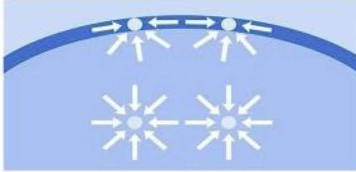
Şekil 2.12. Sıvı moleküllerinin dengesiz kuvvetleri nedeniyle sıvı-katı ara yüzeyindeki yüzey geriliminin şematik gösterimi [16].
